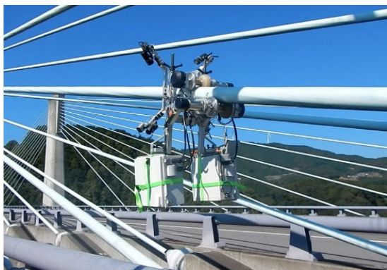
写真3 自走式斜材点検装置
