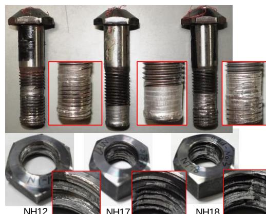
図-6 ねじ山せん断破壊発生したボルトおよびナット
