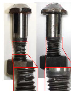
図-4 破断ボルト
