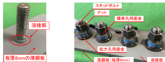
(a) スタッドボルト (b) 継手 図-1 高強度ねじ付きスタッド摩擦接合継手
