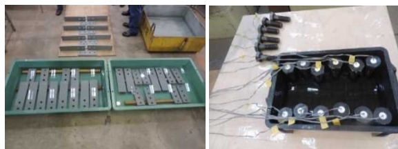
図-2 鋼板とボルトの浸漬状況
