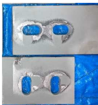
図-3 試験後の接合面 (SH s -C) 上: 母板, 下: 連結板
