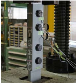
図-4 すべり耐力試験の様子
