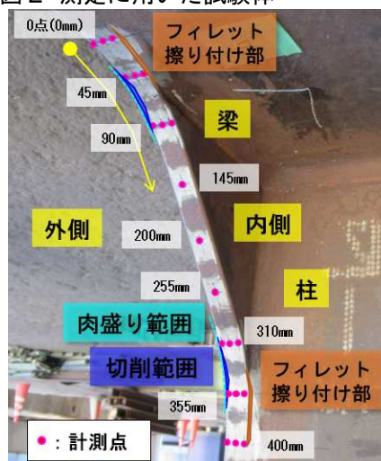
図4 測定箇所及び補修溶接範囲
