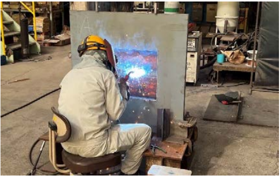
図 4 窓形拘束溶接割れ試験状況
