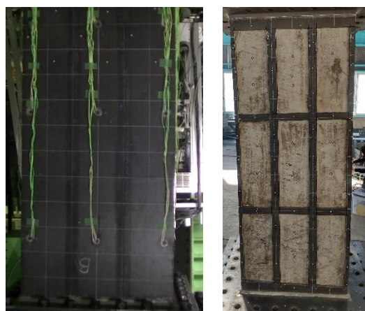
図4 実験後の損傷状況（供試体 3-1）
