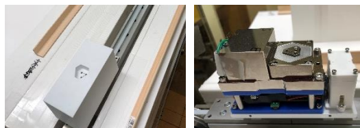
図 3 車両模型 (a)バス模型とレール(左) (b)車両内部(6 分力計, ミニコン搭載)(右)
