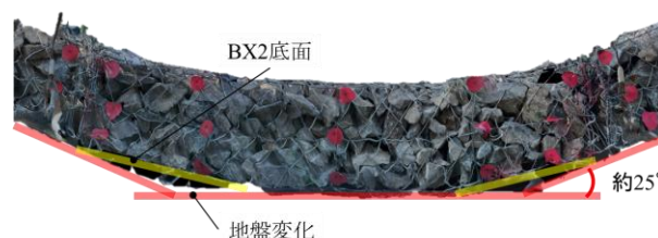
図-7 2段除去時の折れ部付近
