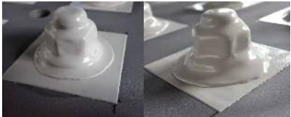
写真-3 a) 2 層塗り b) 3 層塗り 写真-3 2 層, 3 層塗布後の状況
