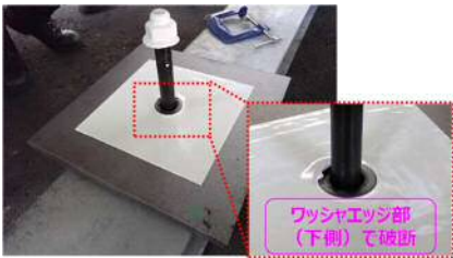
写真-2 突出後の試験体 (No. 1)
