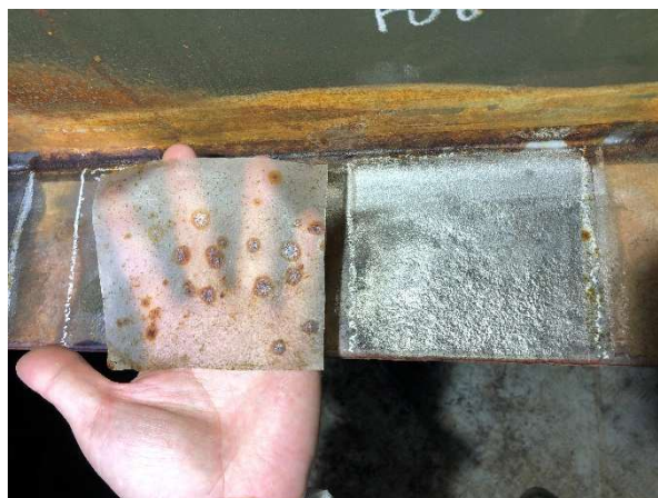
図 3 剥離後の塗膜と処理した鋼材面
