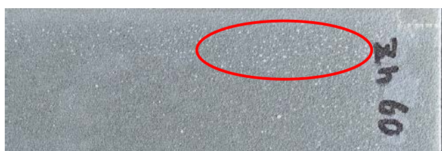
図-1 皮膜表面の白さび（延岡試験場）
