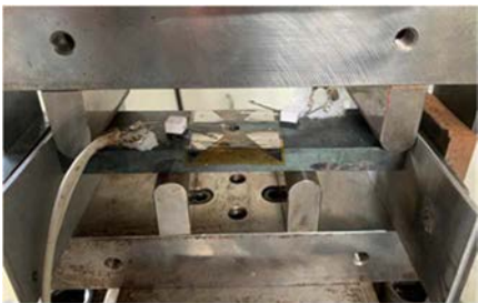
写真1 4点曲げ疲労試験実施状況
