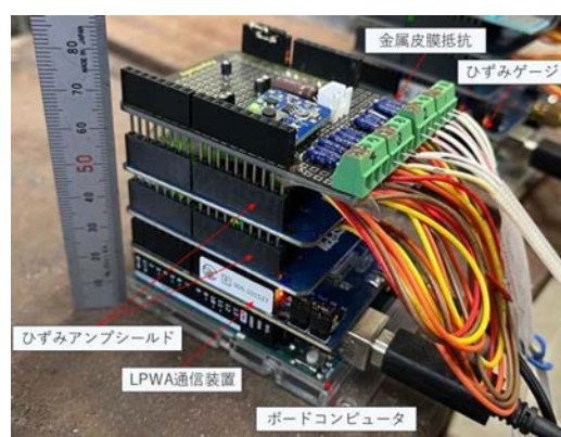
図-1 製作した無線ひずみ計測機器
