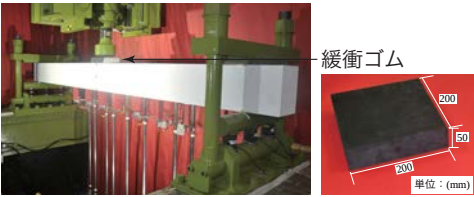
写真1 実験装置と試験体および緩衝ゴム設置状況
