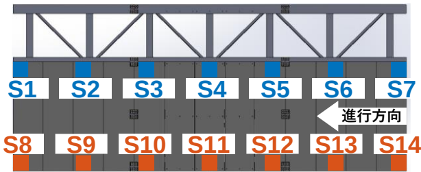
(b) 鋼製模型橋梁の全体図とセンサ位置
