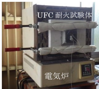
写真-2 小型電気炉の改造
