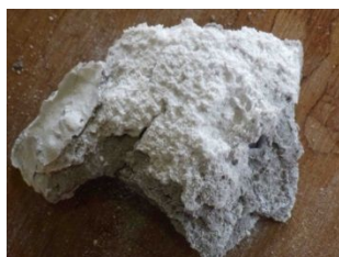
写真-3 試験後の電気炉内と飛散した耐火塗膜
