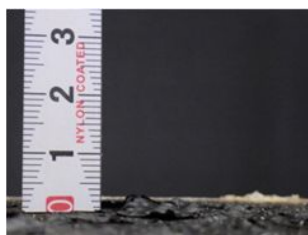
写真-5 各試験体の断面状態（左から耐火塗装膜厚 0, 1500, 3000 \mu\text{m} ）
