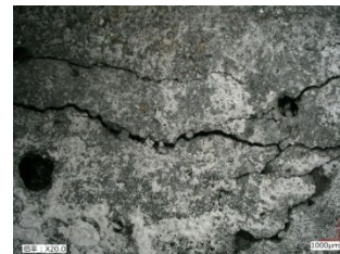
写真-4 試験後の UFC の状態とひび割れ
