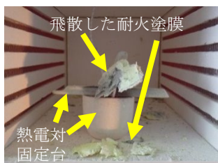
写真-3 試験後の電気炉内と飛散した耐火塗膜
