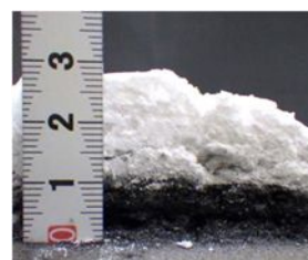
写真-5 各試験体の断面状態（左から耐火塗装膜厚 0, 1500, 3000 \mu\text{m} ）
