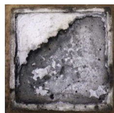
写真-4 試験後の UFC の状態とひび割れ
