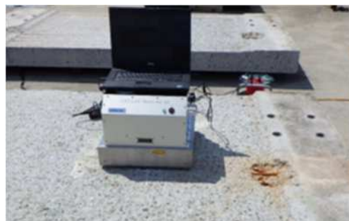
写真-1 きめ深さ測定 (CTメータ)
