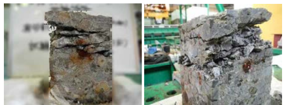
写真-2 圧縮疲労試験による試験体の破壊状況 (パネル 2_No.13)
