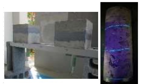
図-7 要素試験体寸法、樹脂注入状況、充填確認
