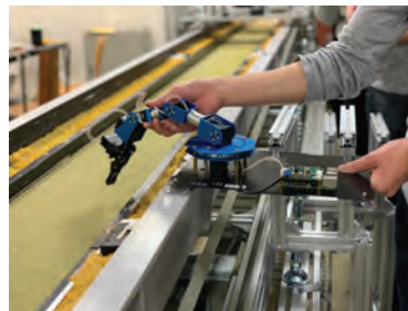
図-4 洪水時の河道を制御するCPSのプロトタイプ
