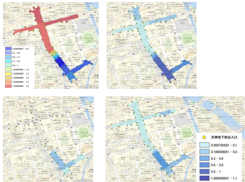
図-4 天神地下街の高低差(左上)と浸水深コンター(右上：止水板なし，左下：case2，右下：case3)
