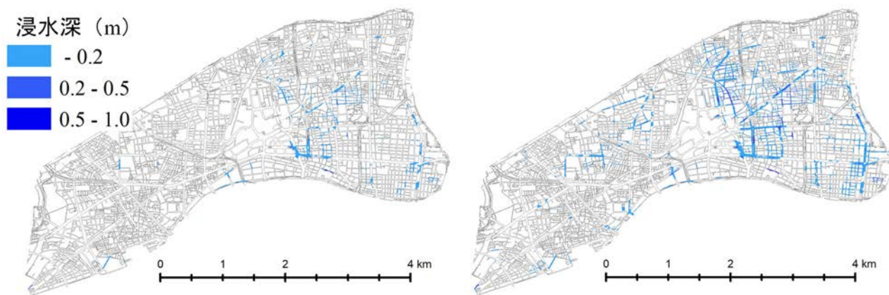
図2 内水氾濫解析による浸水深の分布（左図：過去実験ケース，右図：将来実験ケース）
