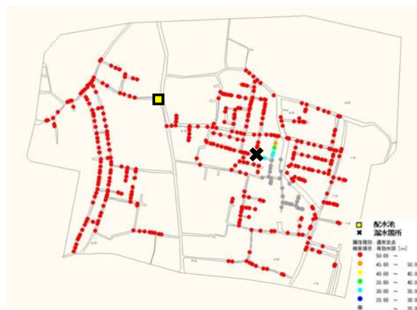
図-1 管網解析による水圧分布 (漏水量: 60 m^3/h )
