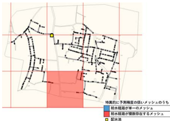
図-5 モデル A での予測精度の低いメッシュの給水経路
