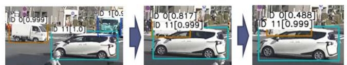
図2 BYTE の適用例 (奥側の車両の軌跡が検出信頼度の低い矩形によって補間され, 軌跡の欠損が防止されている状況)
