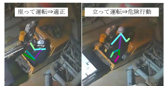
図6 作業員の姿勢による危険作業の判定事例
