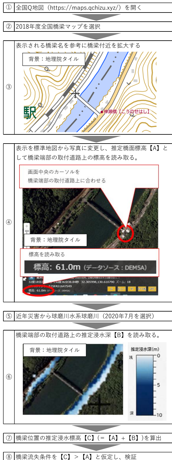
図-1 水害時橋梁流失検討フロー
