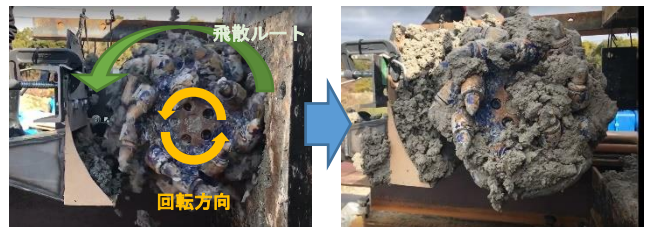
図4 アップカットの吸引結果
