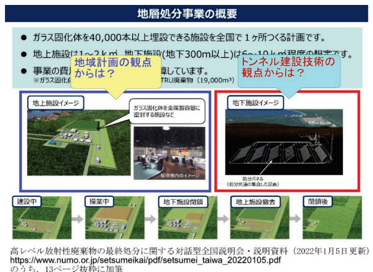
図1 NUMO の対話型住民説明会資料（2022年1月） 1) における地上施設および地下施設の概要（著者の加筆あり）
