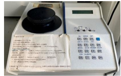
図2 乾式真体積測定装置 (Micromeritics 製 AccuPyc 1330)
