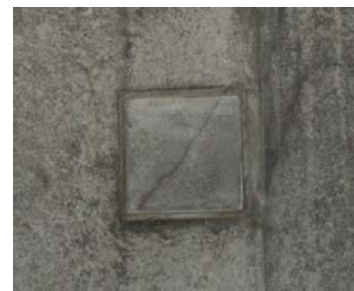
図-6 ひび割れテストピース (幅 0.1mm)
