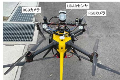
図-2 ドローン及び計測装置
