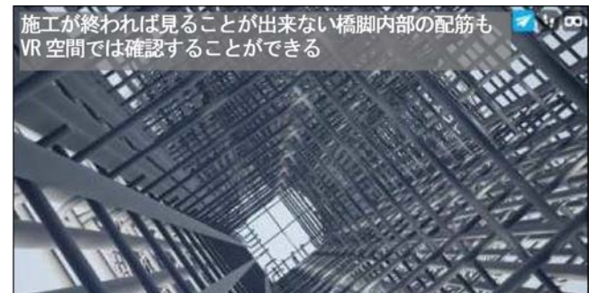
図2 VR橋脚配筋確認モデル
