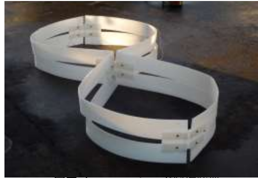
写真-1 スロッシング制振装置
