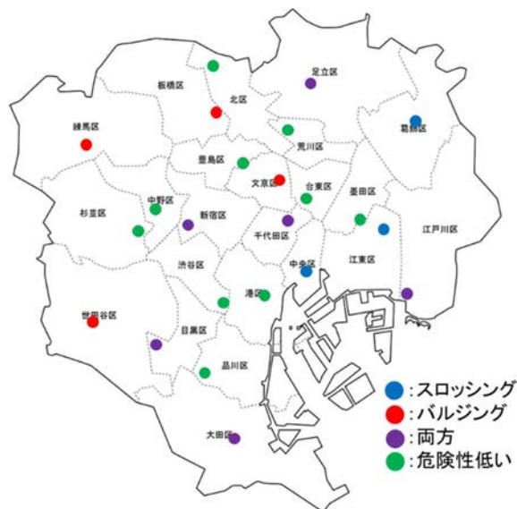
図-5 東京都における k = 0.5 での貯水槽被害の危険性評価
