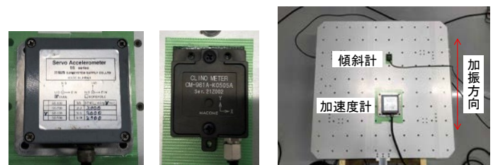
(1)加速度計 (2)傾斜計 (3)振動台
