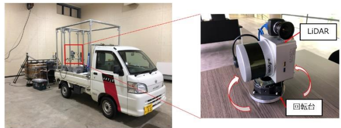
図-2 車両に設置した計測装置
