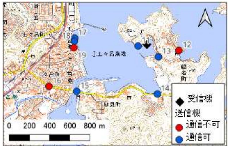
図-2 延岡市土々呂漁港での試験結果 (図中の数字はポイント番号)
