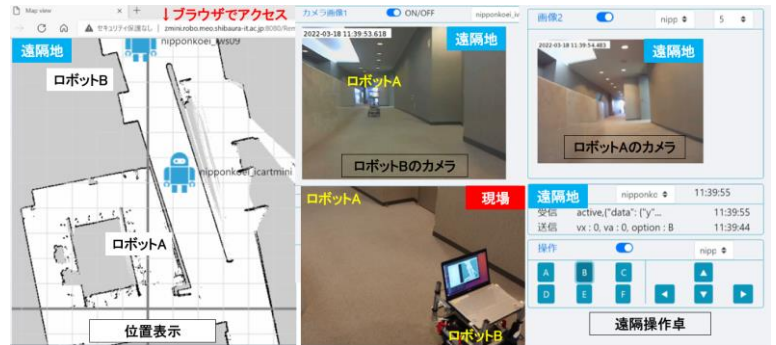
図-2 移動ロボットの動作状況と遠隔地側での受信状況
