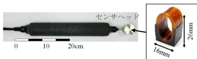
図-1 O-AE とマルチ光計測プローブへの組み込み形態
