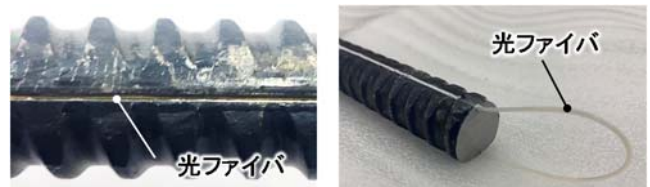
写真-2 光ファイバの取付け方法
