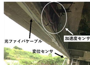
図 3. 光ファイバケーブルとセンサの設置状況
