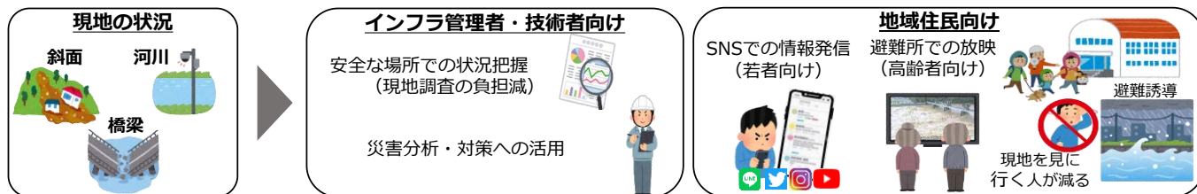
図-1 IoTセンサによる技術者・地域住民への防災情報発信スキームの概要図
