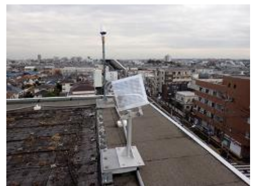
図-2 K-1のGNSSとリフレクターCR-0
