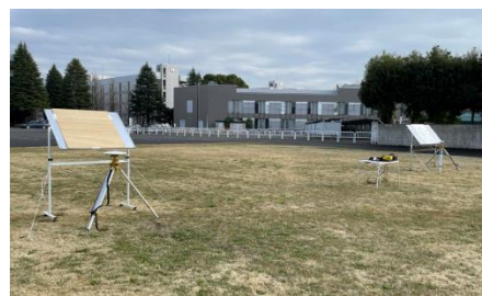
図-1 実験風景 (手前：木材板, 奥側：アルミ板)
