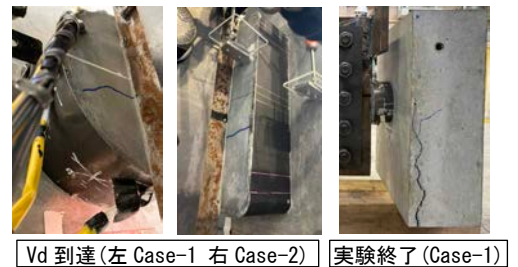
写真-1 せん断試験体損傷状況
