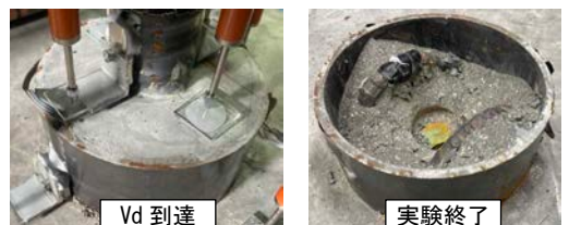
写真-2 引抜き試験体 Case-A 損傷状況
