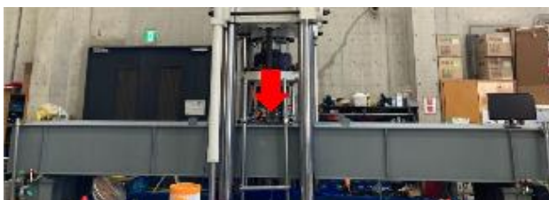
図-2 鋼床版の実験状態
