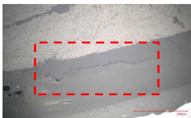
図 4 GF マット接着層のクラック(CASE4)
