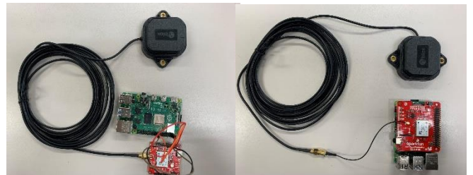
図3 左図は ZED-F9P モジュール、右図は ZED-F9R モジュール
